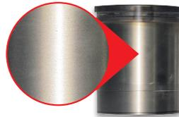
Chemise de cylindre d'un moteur diesel moderne de 15 L après plus de 965 000 kilomètres avec Shell ROTELLA<sup>md</sup> ELC sans nitrite – dépasse les normes actuelles du secteur quant à la protection contre la corrosion.
