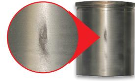
Chemise de cylindre montrant des signes de corrosion par piqûres – satisfait aux normes actuelles du secteur quant à la protection contre la corrosion.
